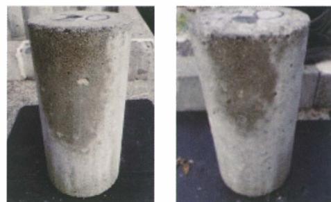
写真-6 複合劣化環境下における15年目の供試体状況（左：シラン・シロキサン系の塗布あり、右：塗布なし）
