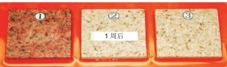
浸泡在用于吸水的标准液中 1 周后的状态
