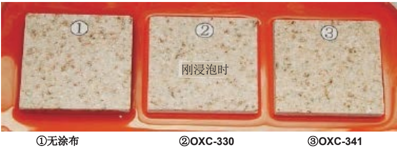
浸泡在用于吸水的标准液中 1 周后的状态
