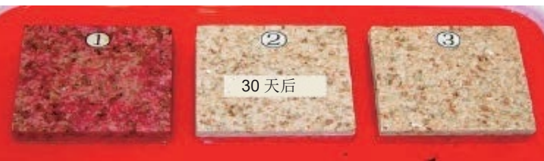
浸泡在用于吸水的标准液中 30 天后的状态
