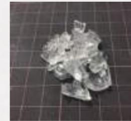
これらのガラス状のシリカゲルに至るまでに要する時間は、通常約1ヶ月～2ヶ月（温度により異なる）程度かかりますが、コンクリート内部の微細な隙間に浸透したコートは硬化後に緻密で硬い層を形成します（右図参照）。
