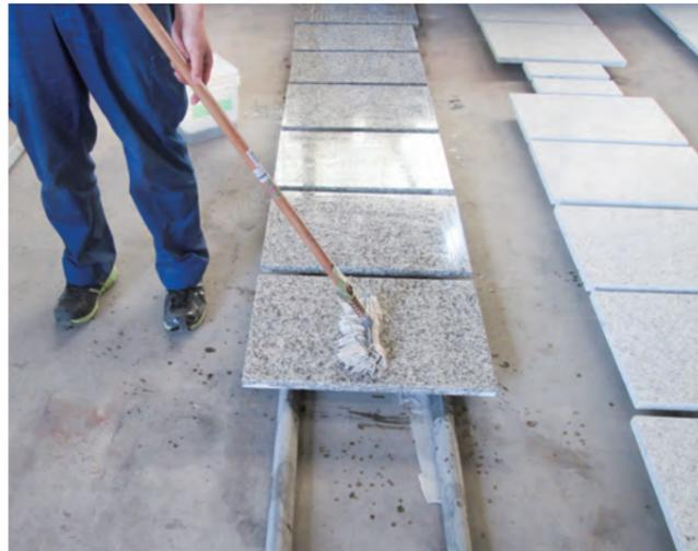
石材切り出し加工後、石張り前に、浸透性の吸水防止剤『OSHIROXコート』を弊社工場にて塗布する事を言います。OSHIROXコートを塗布する事により素材内部に吸水防止層を形成させ素材の吸水率を著しく低下させる事を目的としています。
