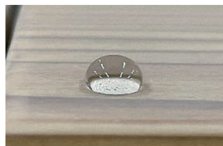
OSHIROX ハイブリッドウッドプロテックス メタルハライドランプ式促進耐候性試験 500h後の表面撥水性 (拡大写真)
