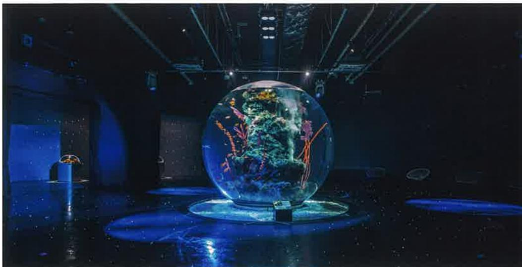
アクリル厚30mmで構築される球体水槽
