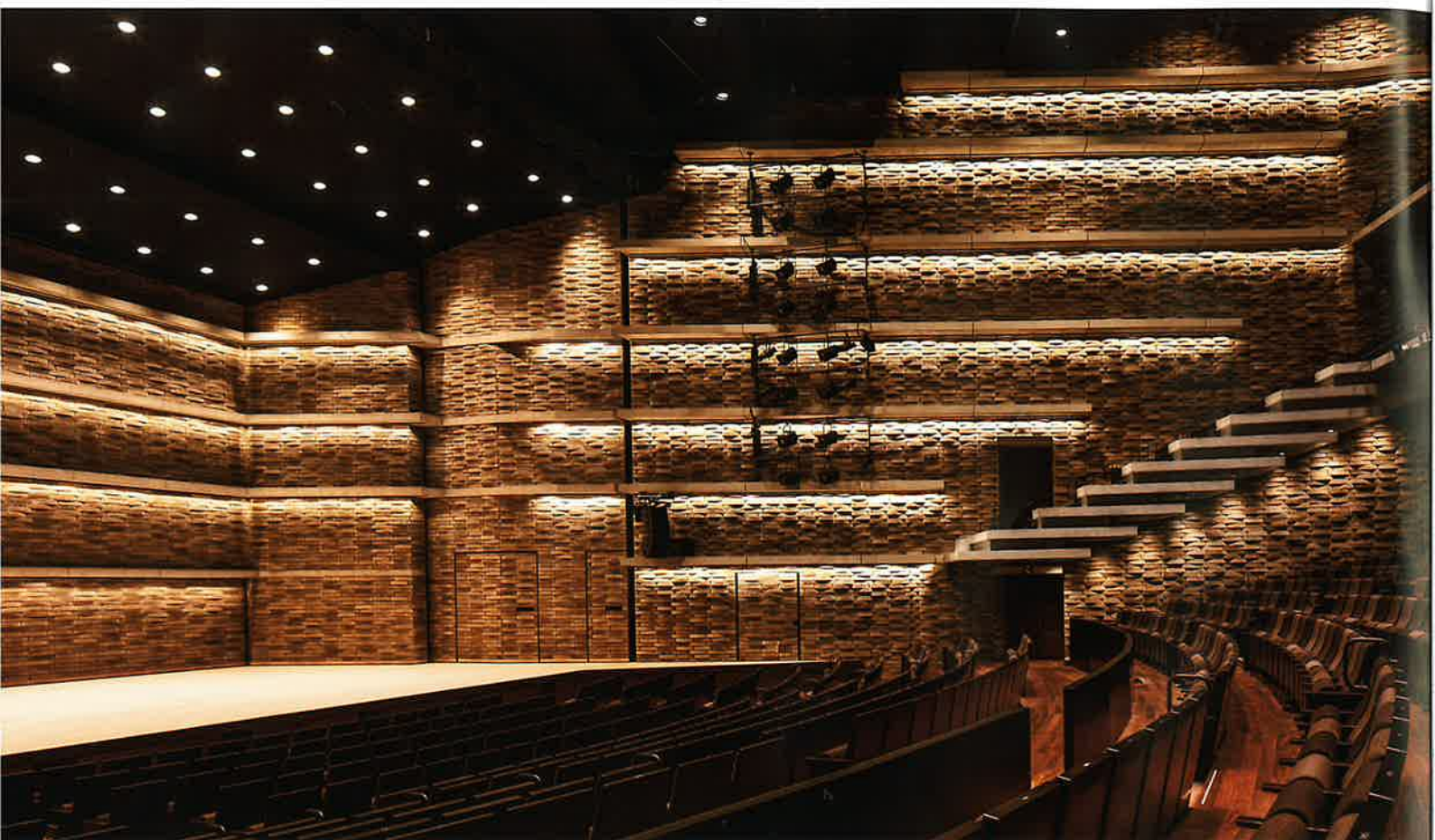
大ホール。ドラフトの発生や高低差による温度ムラの対策として劇場初となる放射パネル空調システムを採用した
