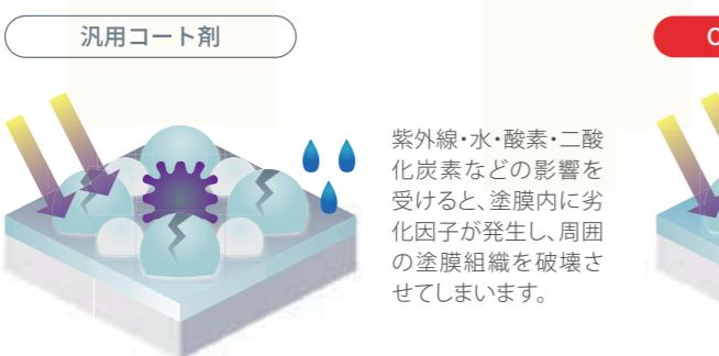
OSHIROXコートは、塗膜を形成し、劣化因子の発生を抑制します。劣化の進行を抑え、高耐久性・高耐候性を高め、各種基材をトラブルから保護します。
