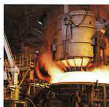
電炉による溶解
