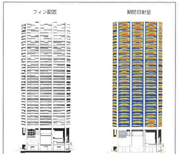
ピーク・年間積算の日射量の両方をチェックしながら、必要な日射遮蔽性能を確保
